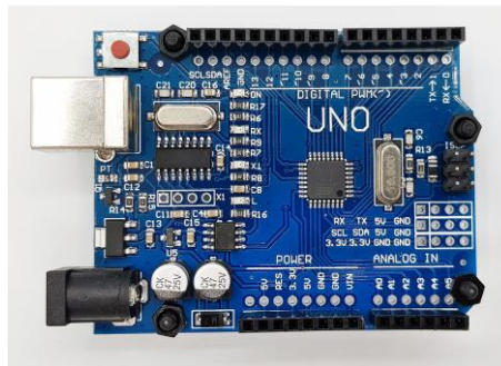
Fig.5. Arduino UNO R3
