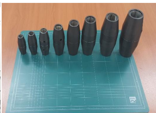
Fig no 5. SIJ for D13, D16, D19, D22, D25, D29, D32, D35
