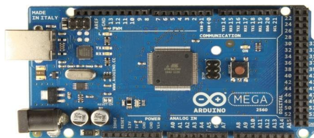
Fig. 10 Arduino Mega R3 2560
