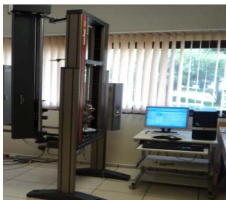
Fig. 3: The «Zwick-Roell» tensile machine.
