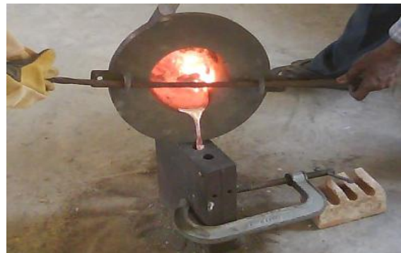
Fig 3.12 Pouring Molten Metal
