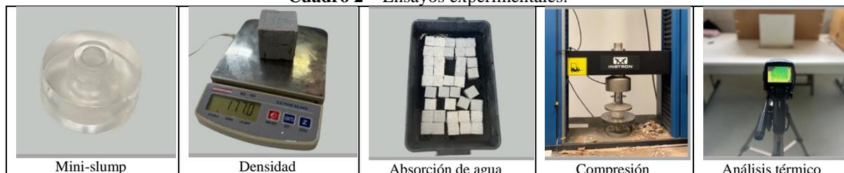
Referente al ensayo de análisis térmico mediante termografía infrarroja (Figura 3), la imagen térmica se realizó de manera activa – en el lado opuesto de la placa al de obtención de las termo gramas – mediante un aparato que contiene dos lámparas infrarrojas (potencia de 250W cada una) durante un período total de 80 minutos.
