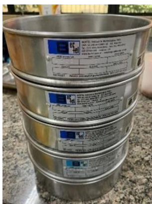
Figura 11 – Série Peneiras Tyler 05, 08, 09, 14 Mesh mais o prato coletor.
