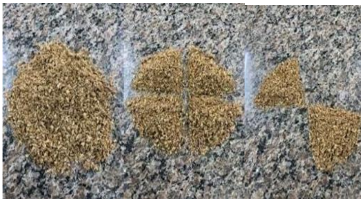
Figura 6: Etapa de quarteamento em amostras secas de resíduo bagaço de malte.
