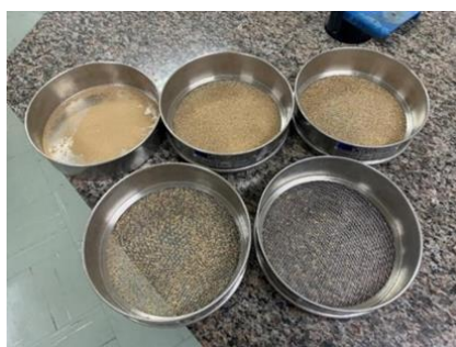
Figura 12 – Série Peneiras Tyler 14, 24, 35, 60 com amostras de bagaço de malte retidas (MSM) vistas por cima.
