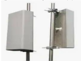
Figure 1.3 : Antenne de transmission et de réception (patch ou monopole UHF)
