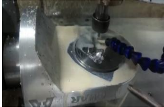
Fig 4 :Wet milling of Co-Cr block
