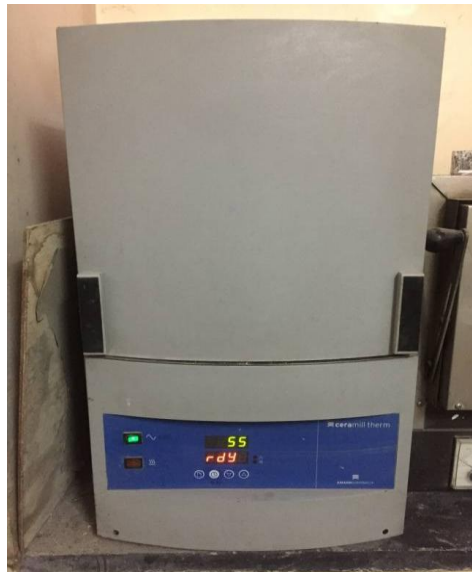
Fig No:5 (Amann Gilbach Furnace)
