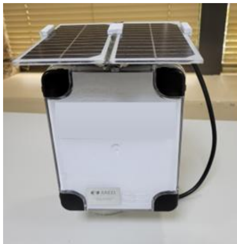
Figura 1 - Equipamento de rádio alimentado por painel solar. Fonte: Autoria própria
